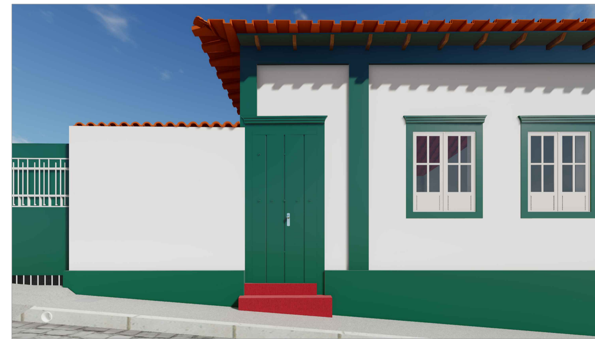
IMAGEM ILUSTRATIVA DETALHE PORTA - SOBVERGA, MADEIRA LATERAL E PISO ESCADA VERMELHO SEM ESCALA
